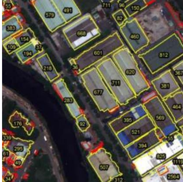
Hình 5.8. Ví dụ lượng điện năng thu được từ điện mặt trời áp mái nhà d. Các bước xác định tiềm năng kỹ thuật điện mặt trời áp mái tại khu vực Ninh Thuận
